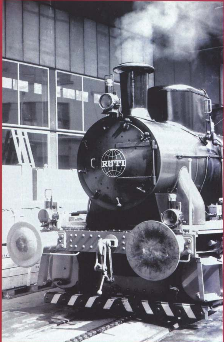
Bild 22: Besonders auffällig sind die großen Pufferteller. Warten auf Arbeit. Die Strubsche Zahnstange ist am Boden zu sehen.
